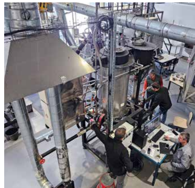
Conception et mise au point d'un réacteur de production d'énergie à partir de résidus agroalimentaires dans la halle Biomasse-énergie [Cirad Montpellier] © D. Jossier, Cirad
