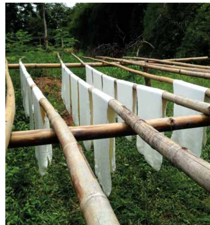
Après dilution et coagulation contrôlée du latex avec de l'acide formique, le coagulum est laminé. La feuille de caoutchouc naturel est séchée à l'air libre sur des bambous. Station de recherche de Kasetsart University, Thaïlande.
