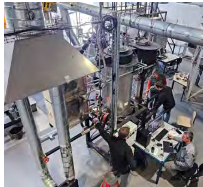
Diseño y desarrollo de un reactor para producir energía a partir de residuos agroalimentarios en la sala Biomasa-Energía (CIRAD Montpellier) © D. Josserond, CIRAD
