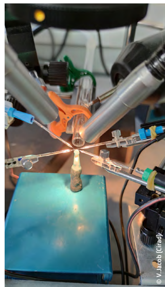
Quatre microélectrodes sont implantées sur un insecte, et un tube de verre délivre des stimulations odorantes.
