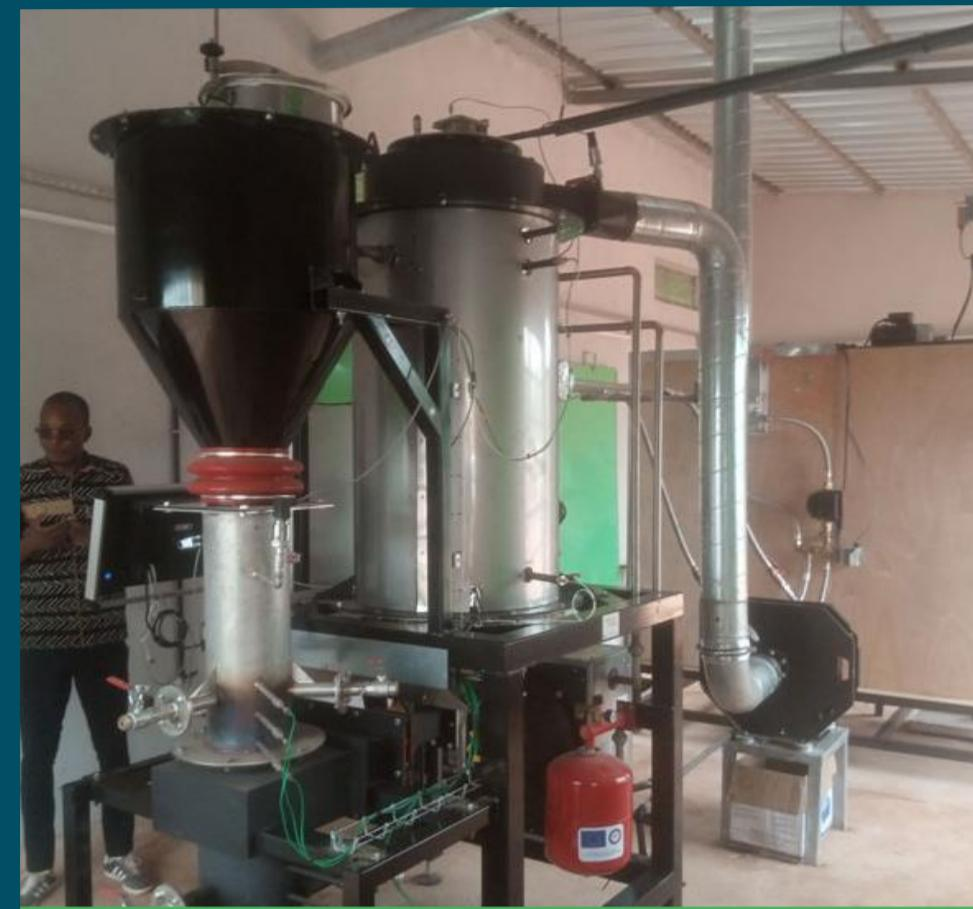
Ce séchoir à mangues a été adapté afin de fonctionner à partir de la chaleur produite par une chaudière à combustion de coques d'anacarde. L'ensemble de ces équipements, destinés aux PME transformatrices de mangues, permet de se substituer au gaz et d'optimiser le séchage.
