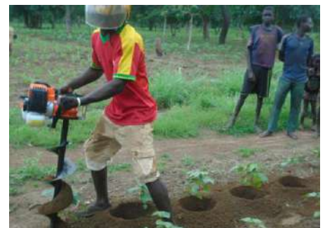
Photo 7 : Utilisation de la tarière pour la trouaison
