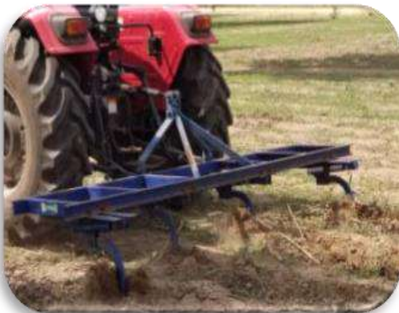
Photo 5: Le cultivateur traçant jusqu'à 4 lignes à la fois
