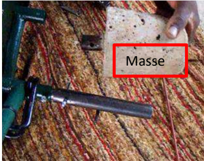
Photo 4, 5 et 6 : Supplément d’une masse sur la roue semeuse Source : Rapport de mécanisation (TAZCO1)
