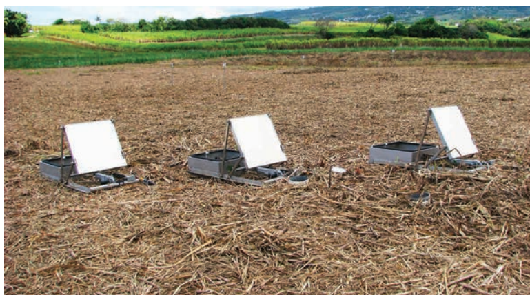
Chambres de mesures de gaz sur le site du Soere Pro à la Réunion
