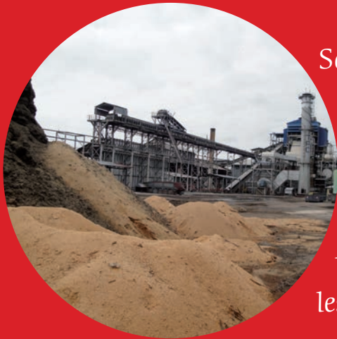
Sucrierie produisant sa propre électricité et une part de celle de la ville voisine à partir de biomasse, Tanzanie. © R. Peltier/Cirad
