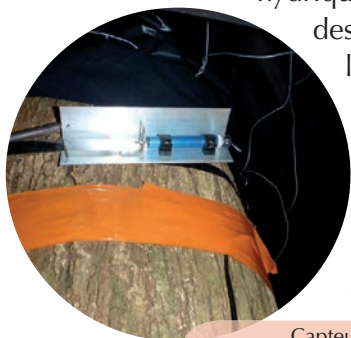
Capteurs de croissance des arbres reliés à la centrale d'acquisition de la station micro-météorologique. © Cirad
