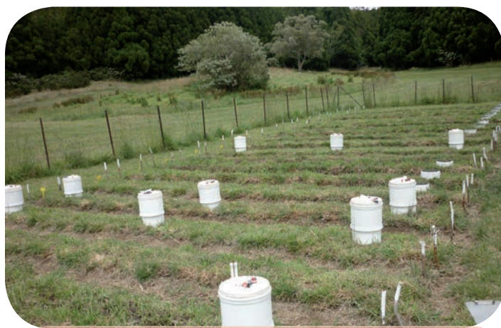
Mesure de l'émission de N 2 O sur prairie d'altitude à la Réunion avec des cloches accumulatrices. © M. Miralles-Bruneau/Cirad
