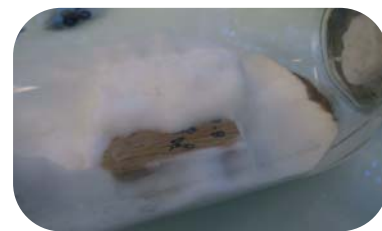
Essai de résistance naturelle du bois de mûrier au champignon tropical Antrodia sp. © N. Leménager, Cirad
