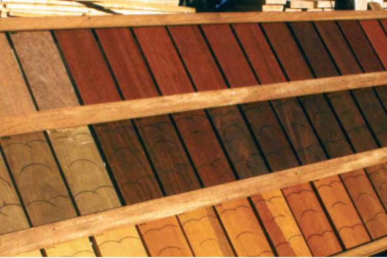
Essais de produits de finition en milieu extérieur.
